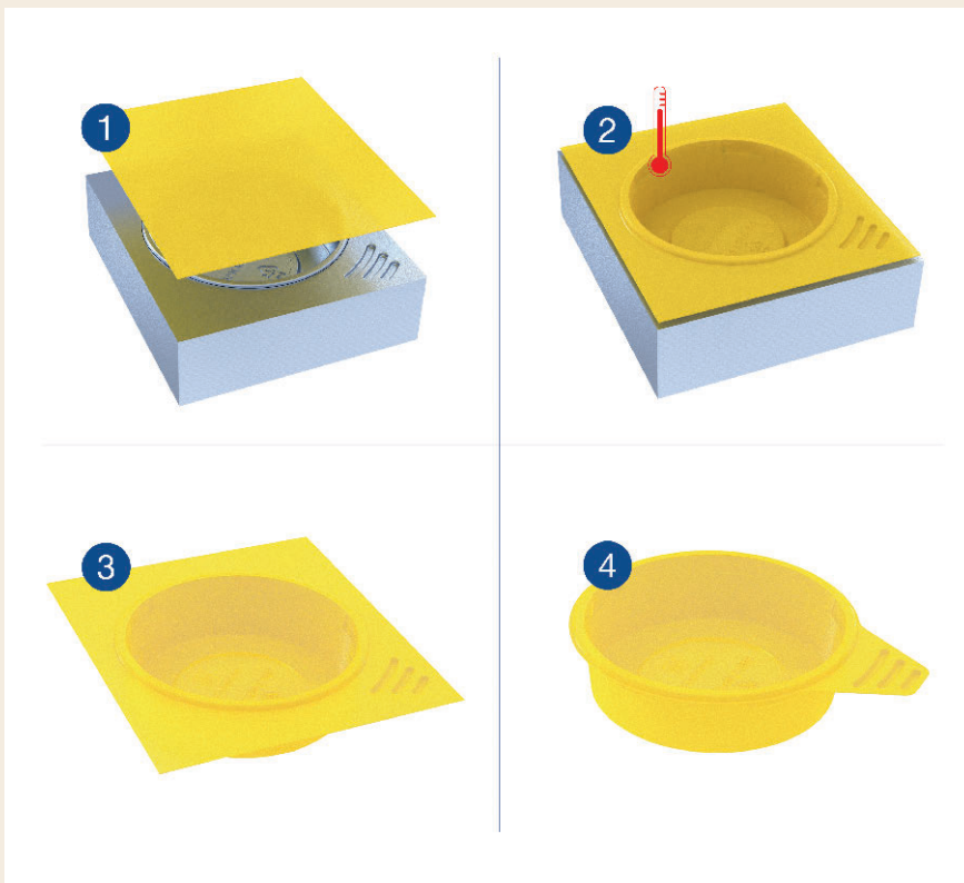
Bild 7 Thermoform-Verfahren: Die vorproduzierte Folie wird in einem speziellen Formwerkzeug (1) unter der Einwirkung von Wärme und Vakuum (2) zu einem Formteil umgeformt und nach Abkühlung aus dem Formwerkzeug getrennt (3). Anschließend wird das Schutzelement ausgestanzt (4). © Bild: Pöppelmann
