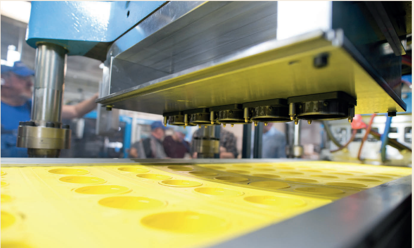
Bild 6 Mit dem Thermoform-Verfahren lassen sich besonders großformatige und dünnwandige Schutzelemente herstellen. © Bild: Pöppelmann
